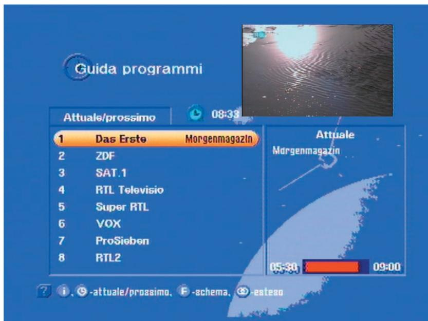
Nella colonna sinistra si vede il numero del canale e il nome come pure il programma attuale. Nella colonna destra si vede il titolo del programma in forma abbreviata nonché un istogramma progressivo che indica il tempo iniziale e finale della trasmissione attualmente selezionata.
