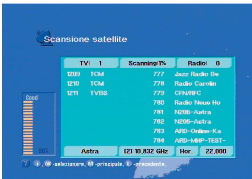
Durante la scansione viene indicata la qualità del segnale, il progresso di scansione come pure i nuovi canali trovati. Alla fine viene visualizzata una segnalazione inerente al termine del ciclo di ricerca.
