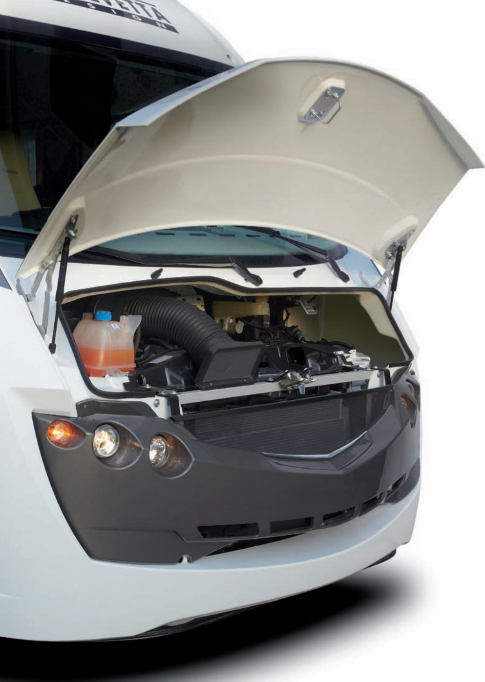
Meccanica e design K-Yacht L'ampia apertura del cofano motore garantisce la massima accessibilità negli interventi di manutenzione. Il carter del cofano motore è studiato per una totale protezione dagli agenti atmosferici.
