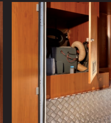
Truma Combi 6 (optional): sistema di riscaldamento acqua ed aria per un comfort costante in ogni condizione climatica.
