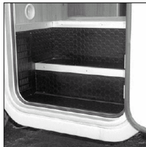
Prese d'aria gradino per la ventilazione permanente
