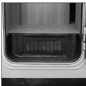
Prese d'aria gradino per la ventilazione permanente
