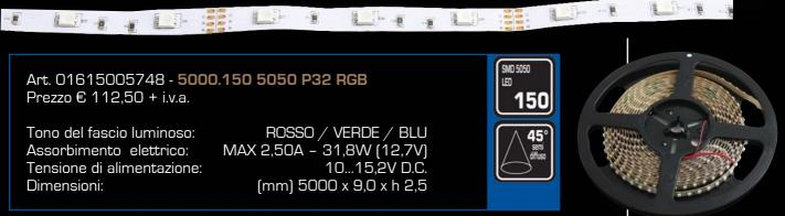
Il modulo con PCB flessibile è composto da 150LEDs con passo 3,2cm per la lunghezza di 500cm. Questo modulo può essere diviso in frazioni di 3 LEDs lunghe 10cm, per l'alimentazione sono presenti 4 cavi saldati, uno corrisponde al positivo comune, gli altri tre corrispondono al negativo dei leds ROSSO/VERDE/BLU. Il fissaggio avviene tramite supporto biadesivo, dove possibile è consigliabile applicare il modulo su superfici metalliche.
