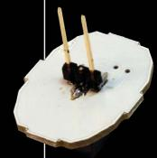
Modulo con **1LED POWER CLN BIANCO CALDO (WW)** o **BIANCO FREDDO (CW)** per sostituire la lampadina alogena da **10W**, disponibile con attacco laterale **G4** e con attacco centrale **VRT**. Dotati di protezione contro l'inversione della polarità, pertanto non occorre prestare attenzione al collegamento dei due poli di alimentazione. Con regolatore di corrente integrato per una luminosità costante al variare della tensione di alimentazione.
