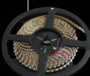
Il modulo con PCB flessibile in bobina è composto da 600 LEDs divisibile in frazioni di 3 LEDs - 2,5cm per la lunghezza totale di 500cm.
