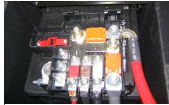
FOTO E: Fusibile batteria auto FIAT
